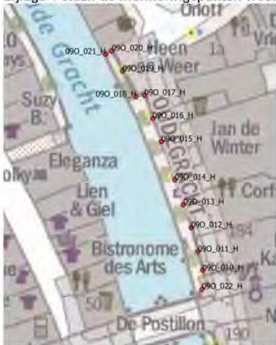
Figuur 2 locaties prisma's aan werfmuur rak 9 oost zuidzijde
