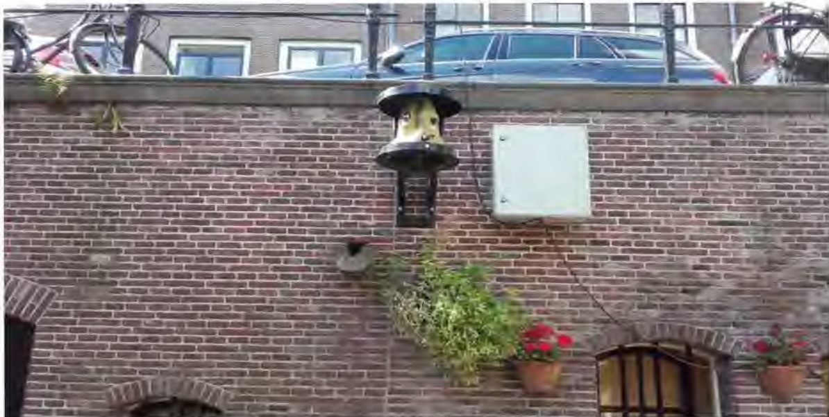
Figuur 5: Voorbeeldfoto Robotic Totalstation Leica TCA 1800
